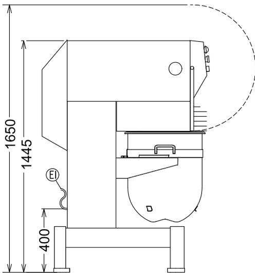
EI = Conexión eléctrica (energía)
